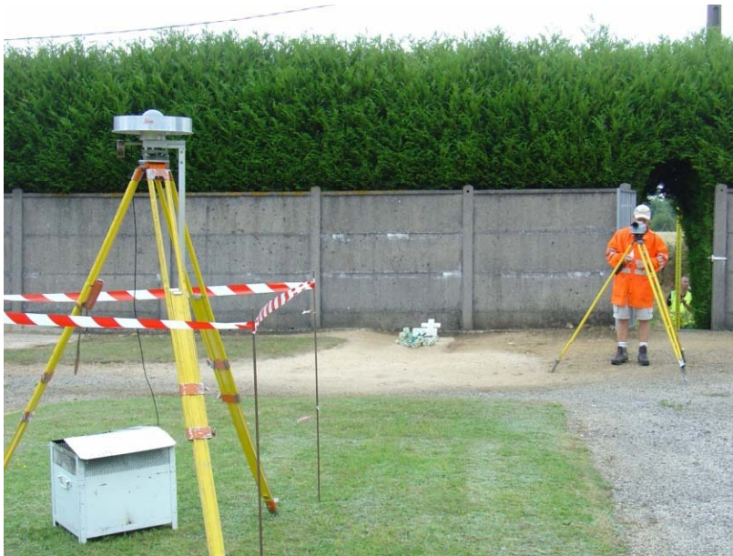
Station GPS calculée avec le RGP (IGN/SGN)
