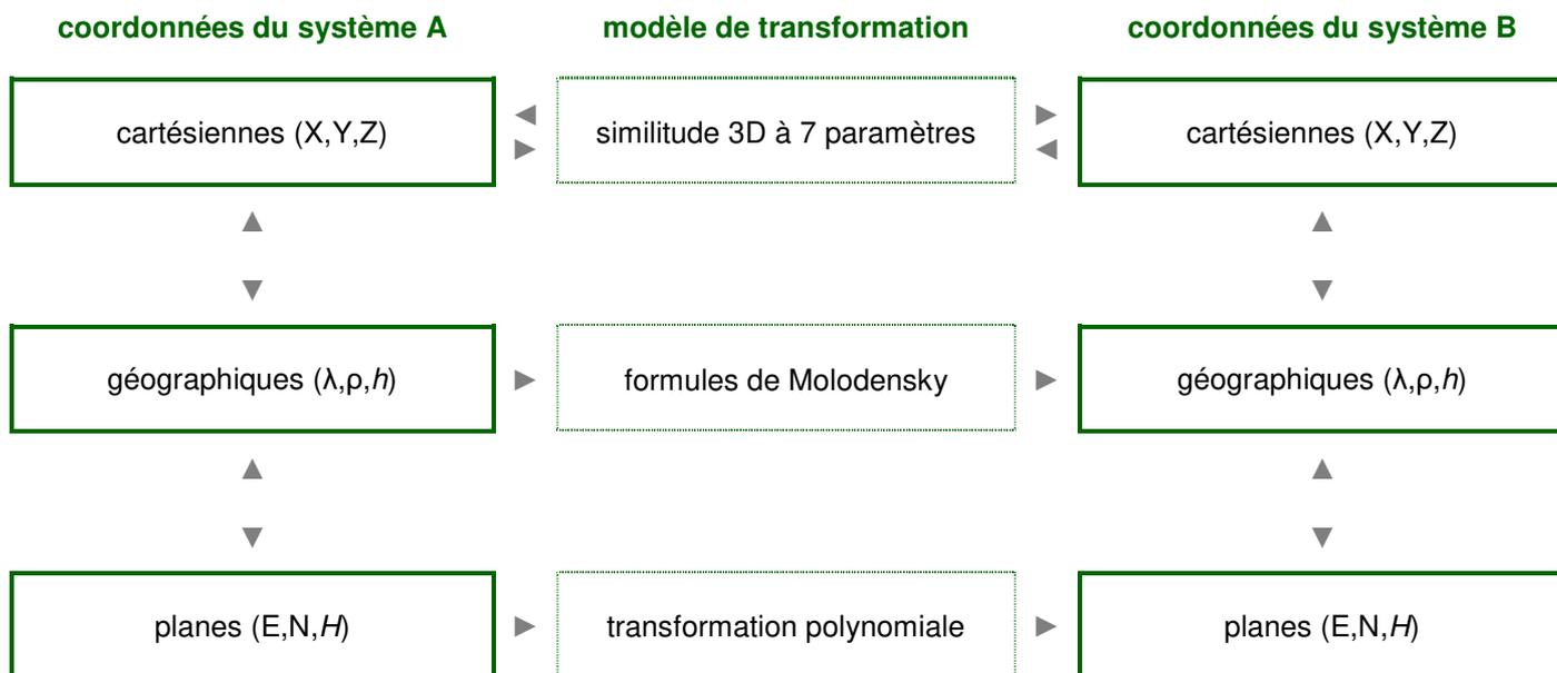
Le plus utilisé est la similitude 3D car elle présente l'avantage de pouvoir être utilisée dans les deux sens : les mêmes paramètres servent à transformer des coordonnées du système A vers le système B et réciproquement, moyennant une simple inversion de signe.
